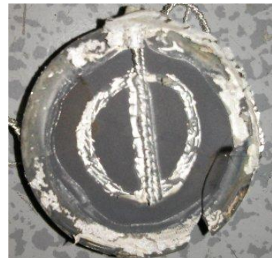
(d) SOFC-6D-6, post-22 hours on biogas
