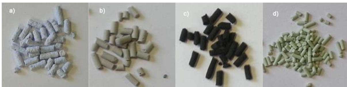
Figure 3.2. Co/ZSM-5 (a), Ni/HY (b), Co/Silica (c) and NiMo/Alumina (d) catalyst pellets.
