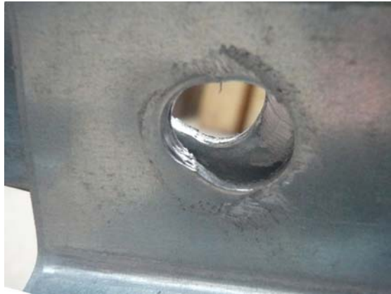
(d) Elongation of bolt holes (common failure pattern)
