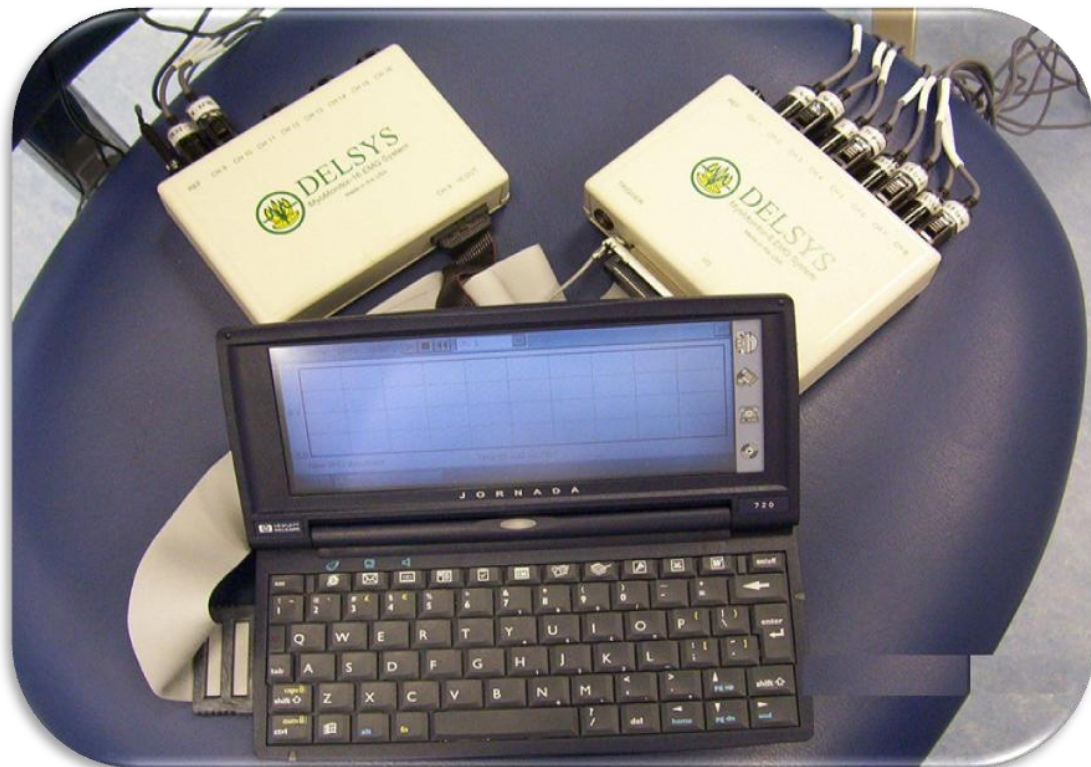
Fig. 6-10. Delsys - MyoMonitor II Portable EMG System ( www.delsys.com )
