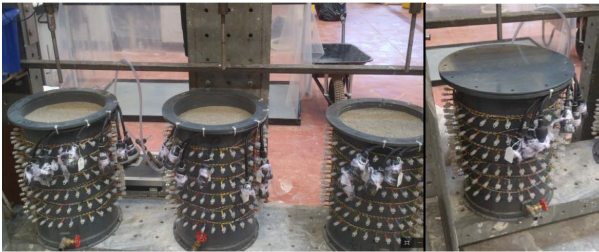
(d) Topping the test cells with the sand layer
