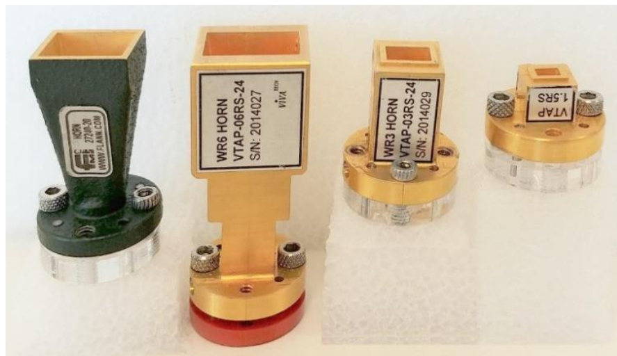
Figure 3.6: Antennas: (a) 79 GHz, (b) 150 GHz, (c) 300 GHz, and (d) 670 GHz.
